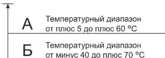
Например, маркировка барьера искробезопасности с температурным диапазоном от плюс 5 до плюс 60 °С будет выглядеть следующим образом: БИ-006-А или БИ-006-01-А.
